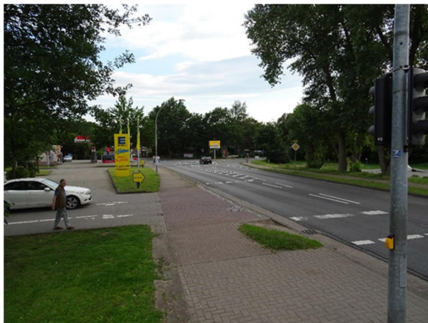
Parkplatzausfahrt Edeka ist signaltechnisch mit der LSA-Querungsstelle verknüpft
